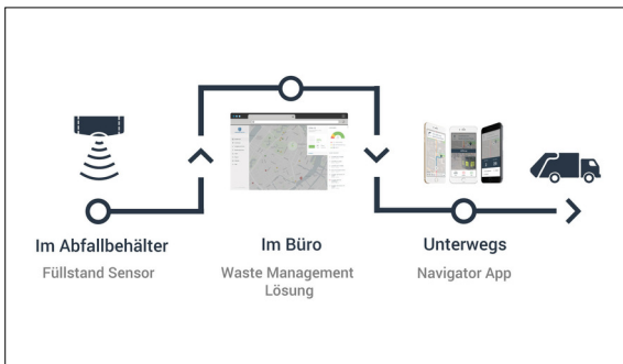
Abbildung 2: Funktionsprinzip der Smart Waste Management Lösung
