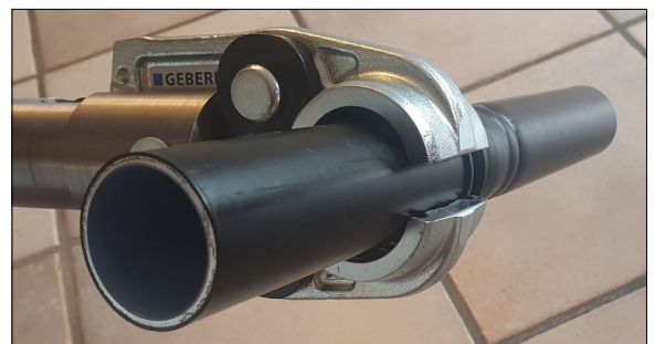
Pressvorgang Rohrverbindung Eigene Darstellung
