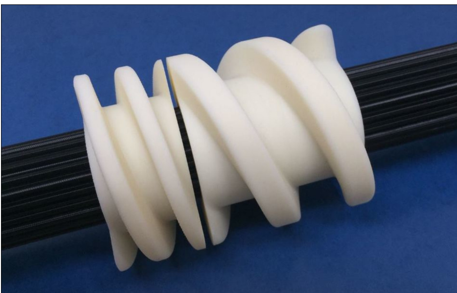
3D-Druck Funktionsmuster der segmentierten Schnecke
